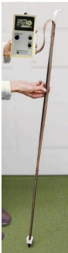
Миллитесламетр EM2 измеряет Земное магнитное поле с разрешением 1нТл (1 гамма). Это разрешение составляет приблизительно 0.002 % типичного магнитного поля Земли.
