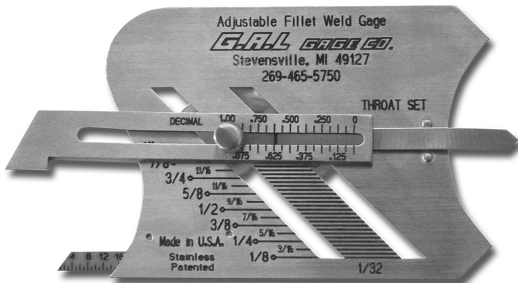
Измеряет любые размеры углового шва с точностью в  $1/32$  " ( 0,8 мм ).
