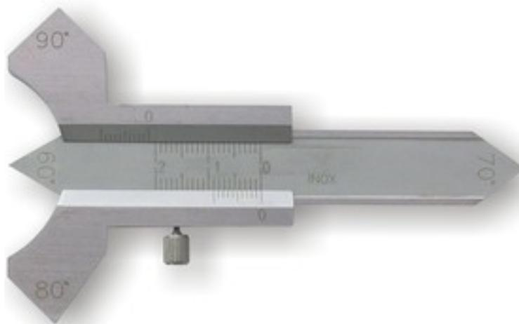
Предназначен для измерения выпуклости сварного шва, угла разделки кромок соединяемых частей угловым и стыковым сварными швами, скоса кромок при подготовке свариваемых соединений деталей, измерения высоты катета углового шва, измерения высоты валика усиления, измерения зазора в соединении при подготовке деталей к сварке.
